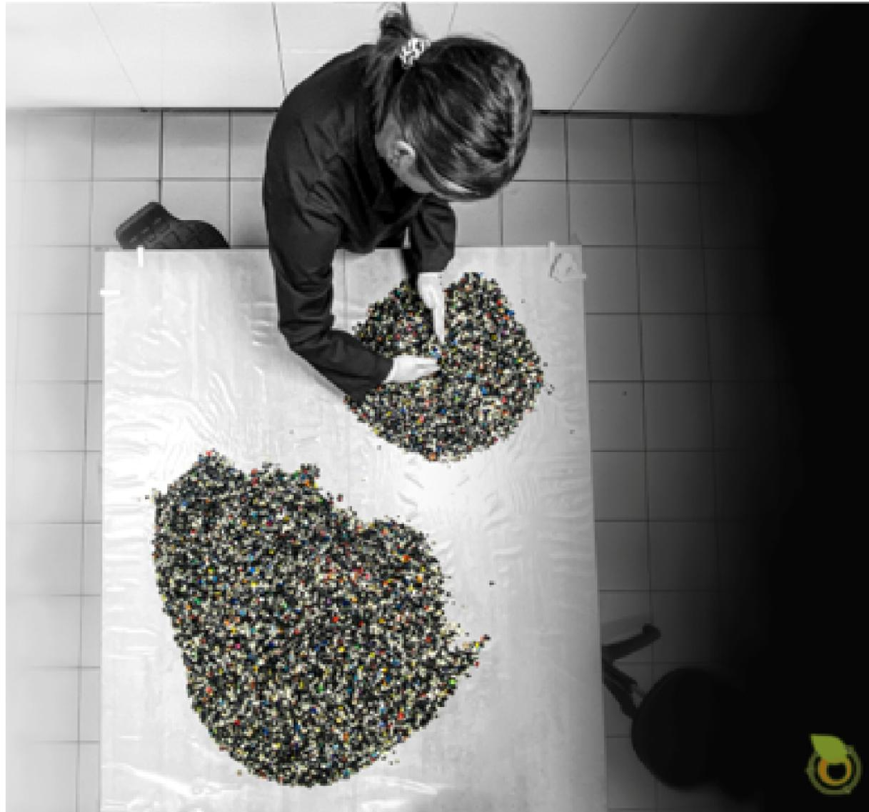
*L'échantillonnage par quartage des plastiques issus des deee, au sein du laboratoire d'Environnement Recycling.*
